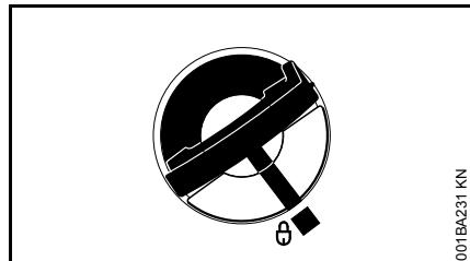
Тогда будут совпадать между собой маркировки на крышке бака и топливном баке
