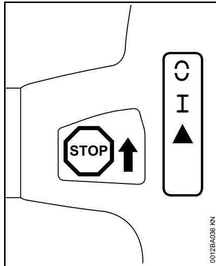
STOP либо C – для выключения зажигания комбинированный рычаг следует нажать в направлении STOP либо C . После освобождения комбинированный рычаг отпружинивает в рабочее положение I.
