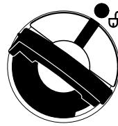
Маркировки на крышке бака и топливном баке должны друг с другом совпадать
