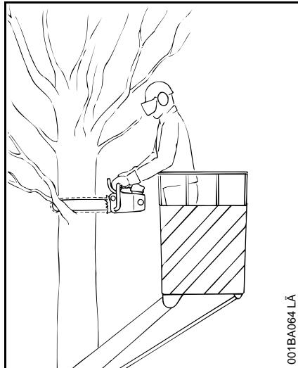
Предпочитательно работать с **подъёмной рабочей площадки**, если это позволяют условия эксплуатации.
